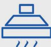
Также опасно использовать вытяжку над газовой плитой! Одновременная работа газовой колонки и вытяжки даже при исправных дымоходе и вентиляционном канале приводит к так называемому «опрокидыванию тяги», из-за чего продукты сгорания начинают поступать в жилое помещение!
